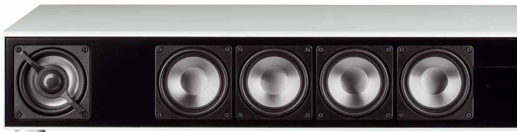
Für den nötigen Schub im Filmbetrieb sorgen vier leistungsfähige 100-mm-Flachmembranchassis auf der Front. An den äußeren Enden sitzen die beiden 100-mm-Koaxialtreiber
